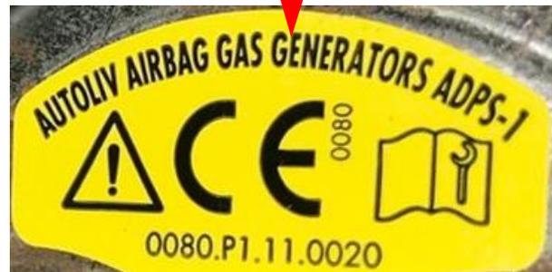
**L'étiquette du coussin gonflable de contrefaçon comporte des erreurs d'orthographe**
